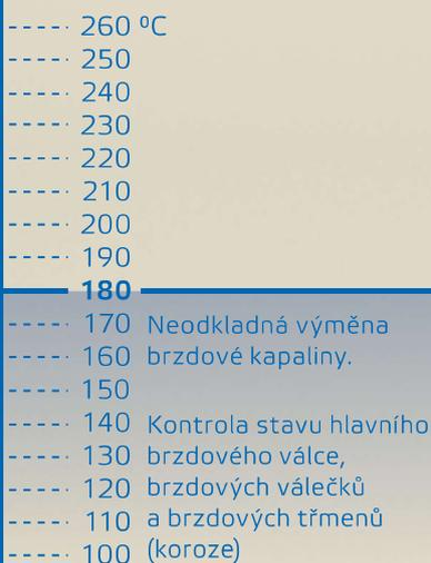
Nechte si pravidelně zkontrolovat aktuální stav brzdové kapaliny a celého brzdového systému – a to minimálně jednou za rok.
