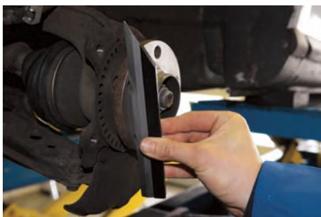
Avant le montage d'un disque de frein, il convient de vérifier la planéité (déformation) du moyeu de roue. Il est particulièrement facile d'y procéder avec la règle de précision ATE suivant la méthode de l'entrefer lumineux. Sa longueur de 200mm permet également d'apprécier sans problème des surfaces plus grandes.
