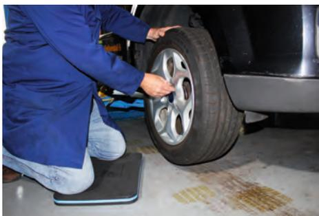
Le tapis pour genoux d'ATE soulage le corps lors de travaux réalisés en position agenouillée au sol et à proximité du sol, le tapis répartissant les sollicitations ponctuelles exercées sur le genou sur une surface plus large, ce qui diminue considérablement la pression sur le genou.
