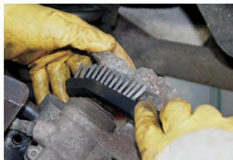
La brosse métallique spéciale ATE sert à enlever les légères impuretés sur les faces de guidage des plaquettes des étriers et supports de freins.
