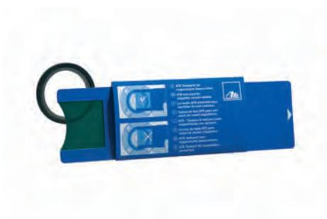
Les capteurs de vitesse de roue actifs fonctionnent avec des roues codeuses magnétiques. Celles-ci sont intégrées dans l'anneau en caoutchouc du roulement de roue. Étant donné que les roues codeuses magnétiques ne peuvent pas être contrôlées visuellement, la carte de test d'ATE est un outil indispensable pour le contrôle des roulements de roues avant le montage, pour déterminer le sens de montage du roulement de roue et pour la recherche d'erreurs en cas de perturbations des signaux de la roue.
