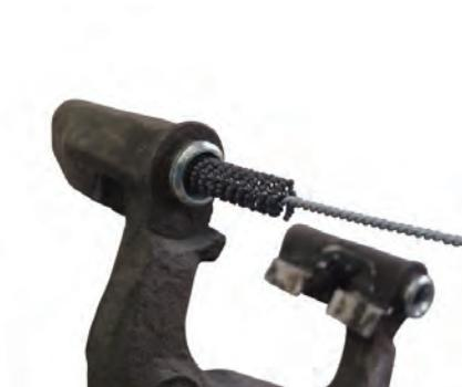
Des goujons de guidage lubrifiés sont utilisés pour l'introduction des étriers flottants "LUCAS". Ceux-ci sont rendus étanches avec des soufflets. En cas de soufflets endommagés, les douilles de guidage sur le support d'étrier de freins se corrodent. Par conséquent, il en résulte des difficultés pour le guidage de l'étrier de freins et d'autres problèmes de freinage.
