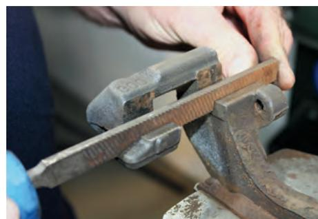
La lime pour rainure d'étrier de frein d'ATE permet de mettre le métal à nu en limant les faces de guidage des plaquettes sur les étriers de frein et les supports de freins. La taille unilatérale permet d'éviter une détérioration du cache-poussière. Les dents grossières spéciales autorisent un travail propre et rapide.
