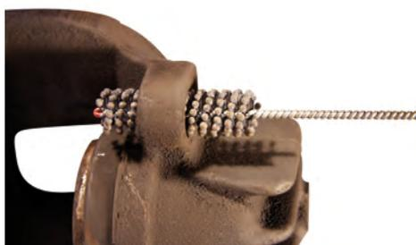
Après une certaine durée de fonctionnement, il peut s'avérer utile de remplacer les manchons de guidage (en caoutchouc) des étriers de freins ATE. L'alésage de réception dans le corps de l'étrier est souvent oxydé, de façon plus ou moins prononcée. Ceci provoque le serrement du manchon de guidage et le blocage des boulons de guidage. L'étrier de frein ne peut plus se déplacer librement, ce qui entraîne d'autres problèmes de freinage.
