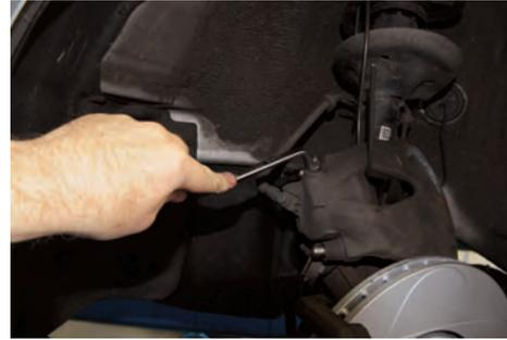
Le jeu de clés de purge d'air spéciales d'ATE est composé de clés à anneaux spéciales contrecoudées. Grâce à leur coude court et leur court long, elles permettent d'ouvrir et de fermer facilement les vannes de purge d'air sans démonter les roues.
