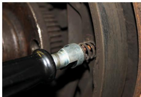
L'outil de montage des ressorts ATE sert au démontage et au montage sûr et sans problème des coupelles de maintien des ressorts de retenue des mâchoires de freins. Mise en place sûre des petites et moyennes coupelles de ressorts des ressorts de retenue des mâchoires de freins grâce à deux entonnoirs de mise en place de différentes tailles.
