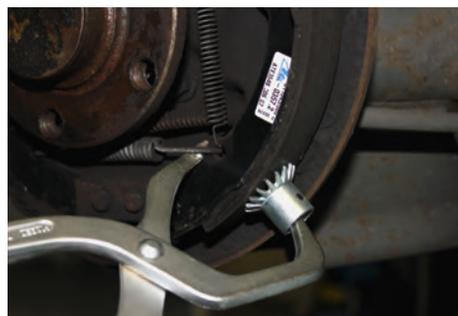
La pince (moyenne) pour ressort de frein ATE permet de démonter et de monter très simplement et sûrement les ressorts de rappel des mâchoires de freins sur les freins à tambours. La petite coupelle d'appui articulée s'appuie sûrement, même sur l'étroite surface des garnitures de freins, grâce à sept crampons pointus. Le crochet autorise un accrochage du ressort.
