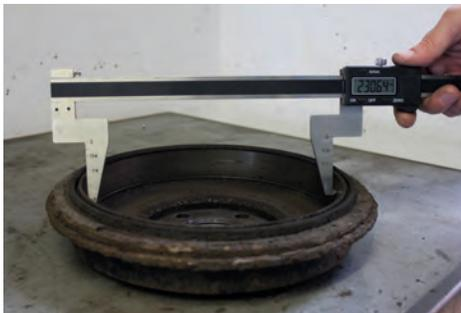
Le pied à coulisse numérique pour tambours de freins d'ATE est un instrument indispensable pour pouvoir déterminer de façon précise le niveau d'usure des tambours de freins. Il permet de mesurer rapidement et facilement l'épaisseur ou/et la cote d'usure des tambours de freins. La plage de mesure est de 400 mm. La forme de bras de mesure permet une mesure précise en dépit des bavures éventuelles sur le tambour de frein.
